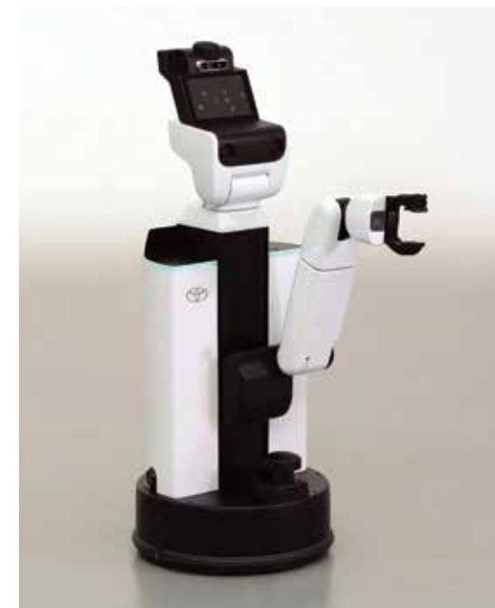
Robot za podporo ljudem – HSR (ang. Human Support Robot) z robotizirano roko lahko pridržijo torbico ali pobere stvari s tal, na prizoriščih udeleženca vodi do sedeža in lahko dostavi lažje predmete.
