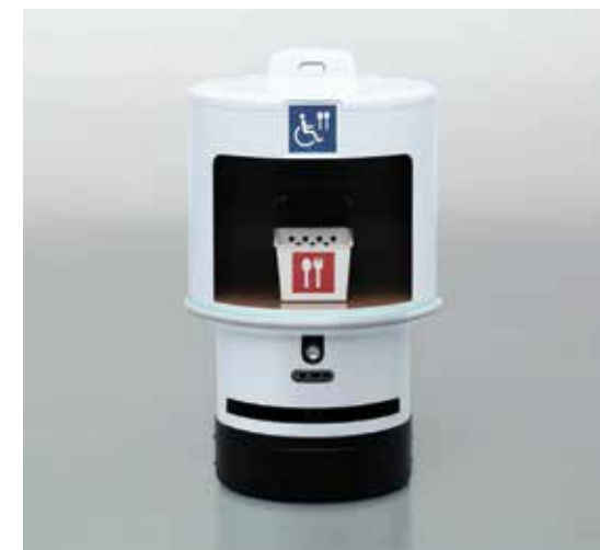
Robot za podporo dostave – DSR (ang. Delivery Support Robot) pa prinese pijačo in prigrizke, naročene kar prek telefonske aplikacije.
